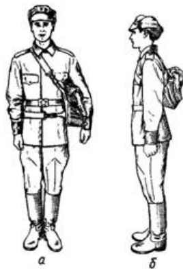
Аппарат ИП-4 (ИП-4М) в положении «наготове»: а - при расположении на боку; б - при расположении за спиной.
