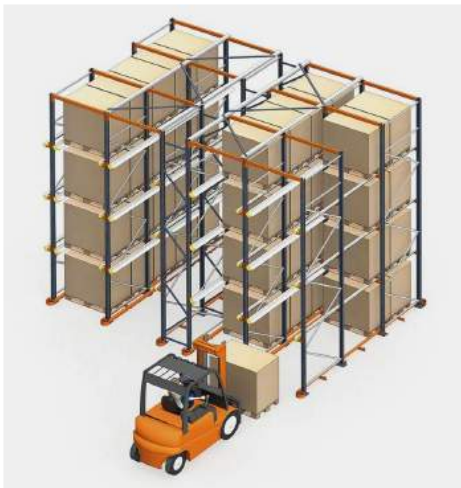
Рисунок 18 – Участок логистики: размещение контейнеров с изделиями на складе готовой продукции при помощи вилочного погрузчика-разгрузчика
