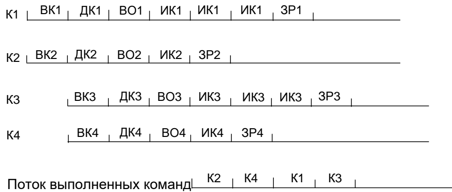
Рис. 1.28. Временная диаграмма не согласованной работы конвейера команд с двумя операционными блоками
