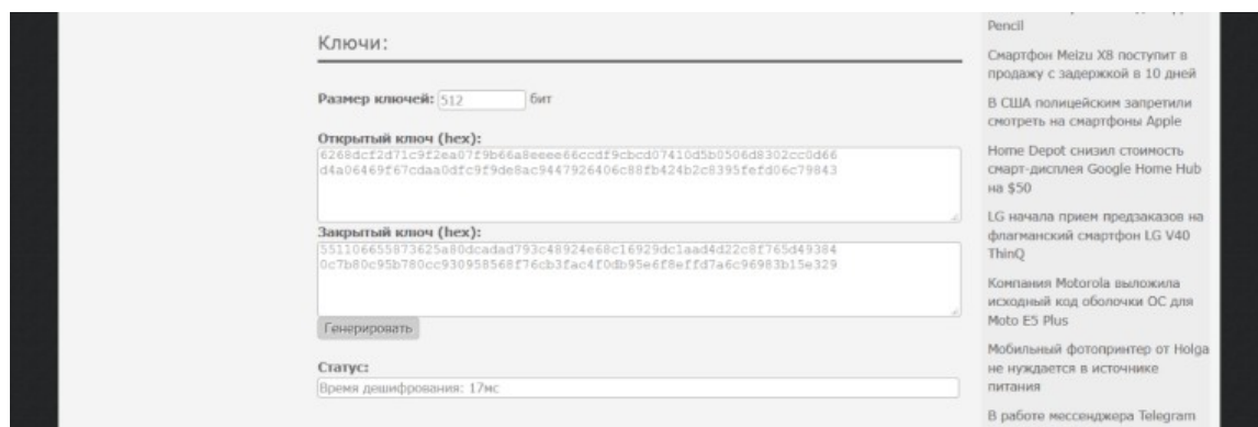
Рисунок 4.1. Генерация пары ключей в алгоритме RSA.
