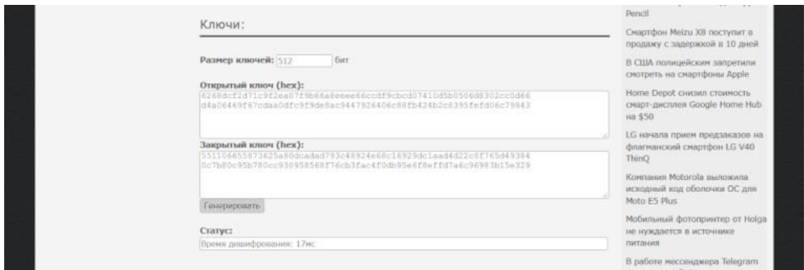
Рисунок 4.1. Генерация пары ключей в алгоритме RSA.
