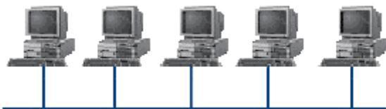
одной линии связи, и информация от каждого компьютера одновременно передается ко всем остальным компьютерам. Согласно этой топологии создается одноранговая сеть. При таком
