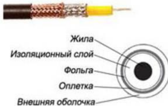
Рисунок 1. Конструкция коаксиального кабеля
