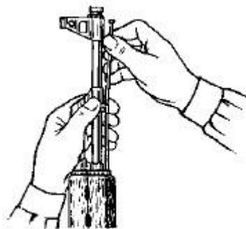
Отделить крышку ствольной коробки.левой рукой обхватить шейку приклада, большим пальцем этой руки нажать на выступ направляющего стержня возвратного механизма, правой рукой приподнять вверх заднюю часть крышки ствольной коробки и отделить крышку.
