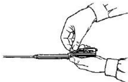
Отделить газовую трубку со ствольной накладкой. Удерживая автомат левой рукой, правой рукой надеть пенал с принадлежностью прямоугольным отверстием на выступ замыкателя газовой трубки, повернуть замыкатель от себя до вертикального положения и снять газовую трубку с патрубком газовой камеры
