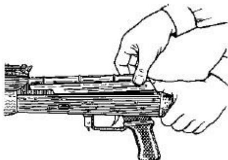
*Отделить возвратный механизм.* Удерживая автомат левой рукой за шейку приклада, правой рукой подать вперед направляющий стержень возвратного механизма до выхода его пятки из продольного паза ствольной коробки; приподнять задний конец направляющего стержня и извлечь возвратный механизм из канала затворной рамы.
