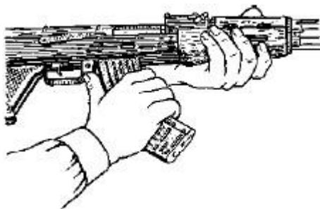
*Вынуть пенал с принадлежностью.* Утопить пальцем правой руки крышку гнезда приклада так, чтобы пенал под действием пружины вышел из гнезда; раскрыть пенал и вынуть из него протирку, ершик, отвертку, выколотку и шпильку.
