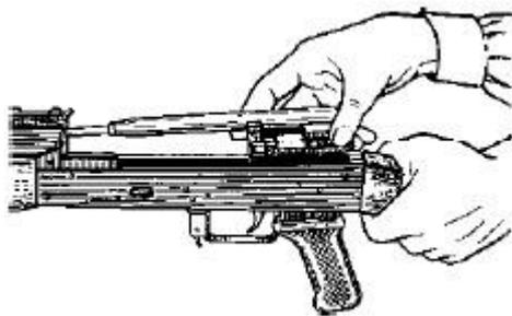
*Отделить затвор от затворной рамы.* Взять затворную раму в левую руку затвором кверху правой рукой отвести затвор назад, повернуть его так, чтобы ведущий выступ затвора вышел из фигурного выреза затворной рамы, и вывести затвор вперед.
