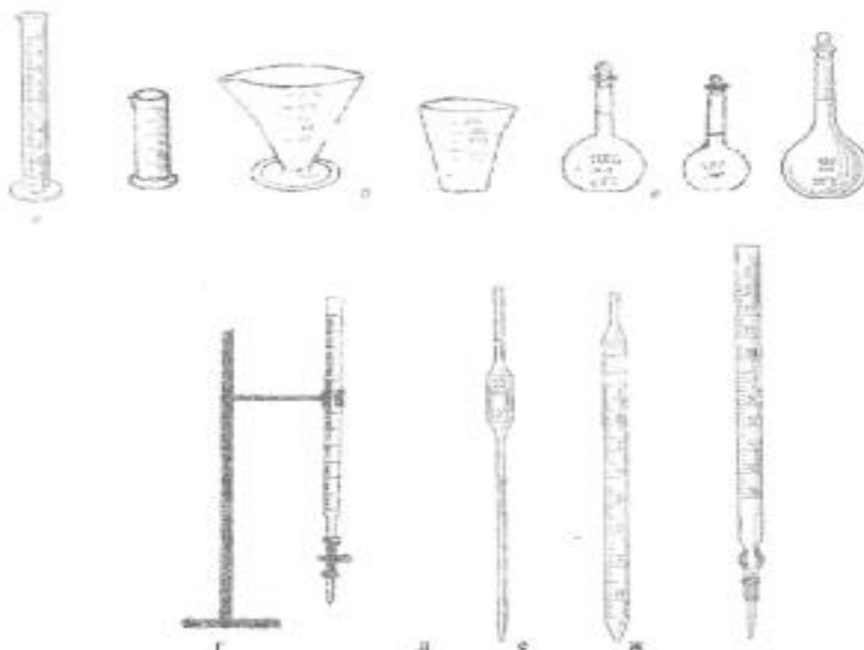
Рис. 7. Мерная посуда: а – мерные цилиндры; б – мензурка; в – мерные колбы; г, ж – бюретки с различными затворами; д – обыкновенная пипетка; е – градуированная пипетка
