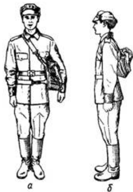
Аппарат ИП-4 (ИП-4М) в положении «наготове»: а - при расположении на боку; б - при расположении за спиной.
